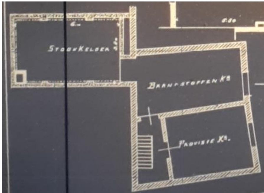
Plattegronden van de kelders onder het achterste gedeelte van het voormalig weeshuis (Provisie, rechtsonder) en onder de uitbreiding van 1913 (brandstoffen, rechtsboven) en onder de binnenplaats achter het pand van Perkswaltje 26 en voormalige Nauwe Gasthuissteeg (Stoomkelder, linksboven). Blauwdruk 1928. Bron: HCL
